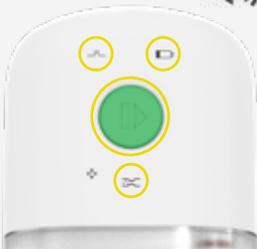
Alle Anzeigeleuchten blinken in schnellen Intervallen. Die Pumpe gibt wiederholt einen Alarm (Signalton) aus und geht dann in den Pausenmodus.
