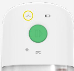
Die Anzeigeleuchte **UNDICHTIGKEIT** leuchtet 1 x pro Sekunde auf. Die Pumpe gibt wiederholt einen Alarm (Signalton) aus und geht dann in den Pausenmodus.
