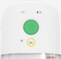
Die Anzeigeleuchte **BLOCKADE** leuchtet 1 x pro Sekunde auf. Die Pumpe gibt wiederholt einen Alarm (Signalton) aus und geht dann in den Pausenmodus.
