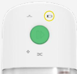
Die Anzeigeleuchte **BATTERIESTAND NIEDRIG** leuchtet einmal alle fünf (5) Sekunden auf.
