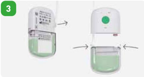
Lösen Sie den Schlauch an der Rückseite der Pumpe. Drücken Sie kräftig auf die seitlichen Laschen und ziehen Sie mit leichtem Ruckeln, um den Kanister zu trennen. Bringen Sie den neuen Kanister an. Sie können damit rechnen, dass der Kanister sehr fest sitzt. Das ist normal und notwendig, um eine wirksame Dichtung aufrechtzuerhalten.
